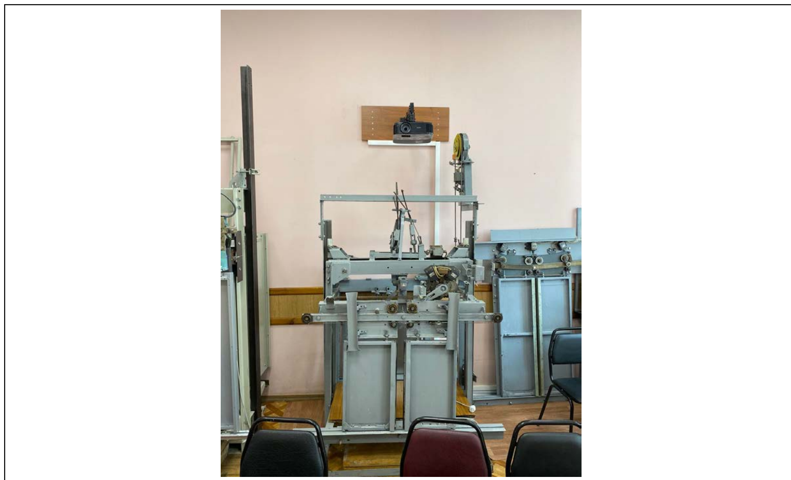
Модель кабины пассажирского лифта, привод дверей шахты
